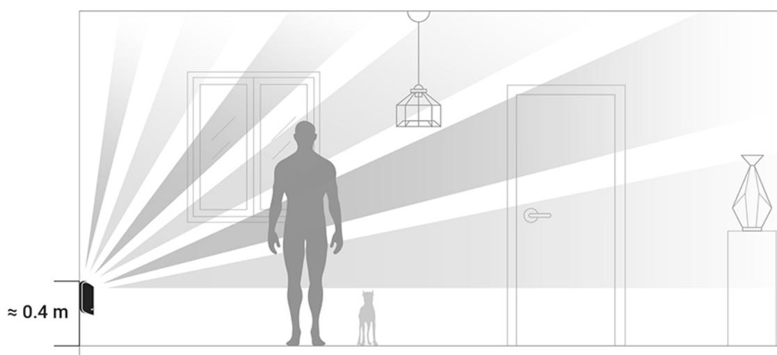
La ubicación de MotionProtect Curtain depende de la distancia al hub y de los obstáculos entre los dispositivos que pueden dificultar la señal de radio: paredes, suelos, objetos masivos en la habitación.
