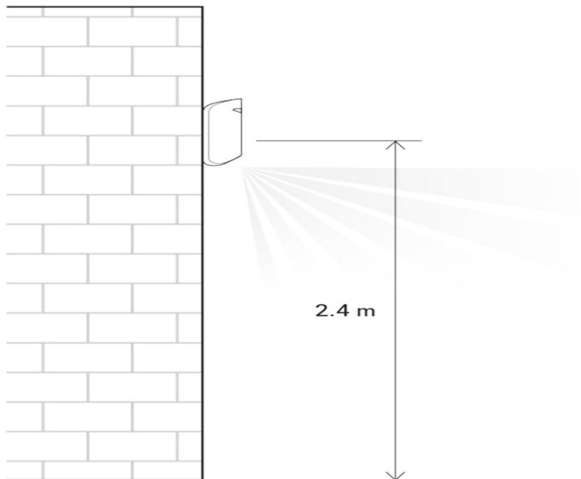
La instalación del detector a una altura diferente a la recomendada reduce la zona de detección y puede afectar a la calidad de la detección de movimiento.
