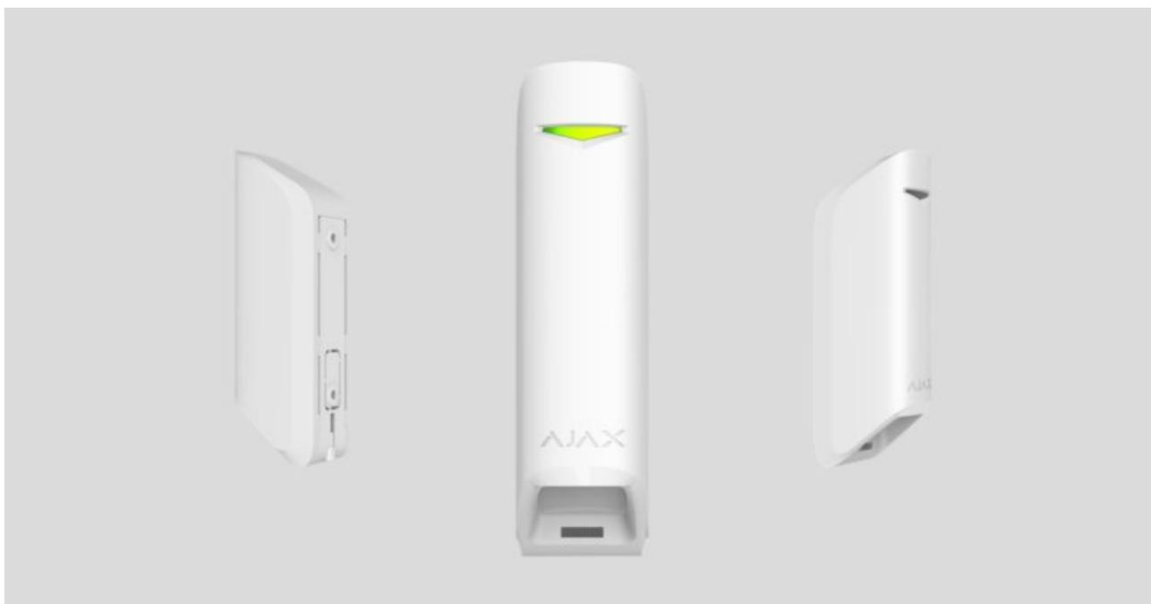
**MotionProtect Curtain** es un detector inalámbrico de movimiento tipo cortina. El detector tiene un ángulo de detección horizontal estrecho y está diseñado para controlar el perímetro interior: proteger ventanas, puertas y otras entradas y salidas en la instalación protegida. MotionProtect Curtain reconoce el movimiento a una distancia de hasta 15 metros.
